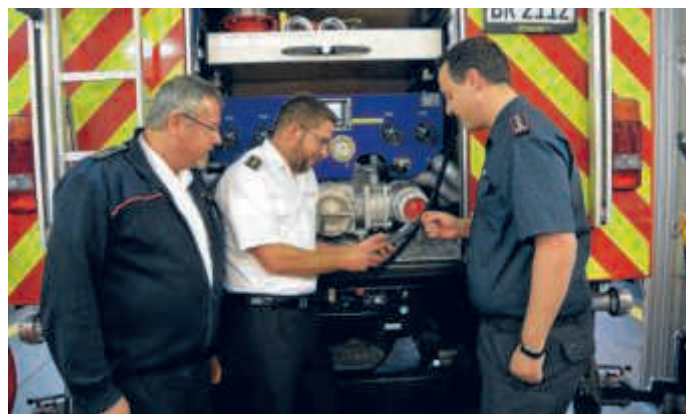
Kommandant Marco Krupp (r.) zeigt Kreisbrandmeister Udo Dentz (v.l.) und Andreas Schmidt vom Innenministerium das Digitalfunkgerät, das sich neben der Pumpe im Hilfeleistungslöschgruppenfahrzeug befindet. Foto: Feuerwehr
