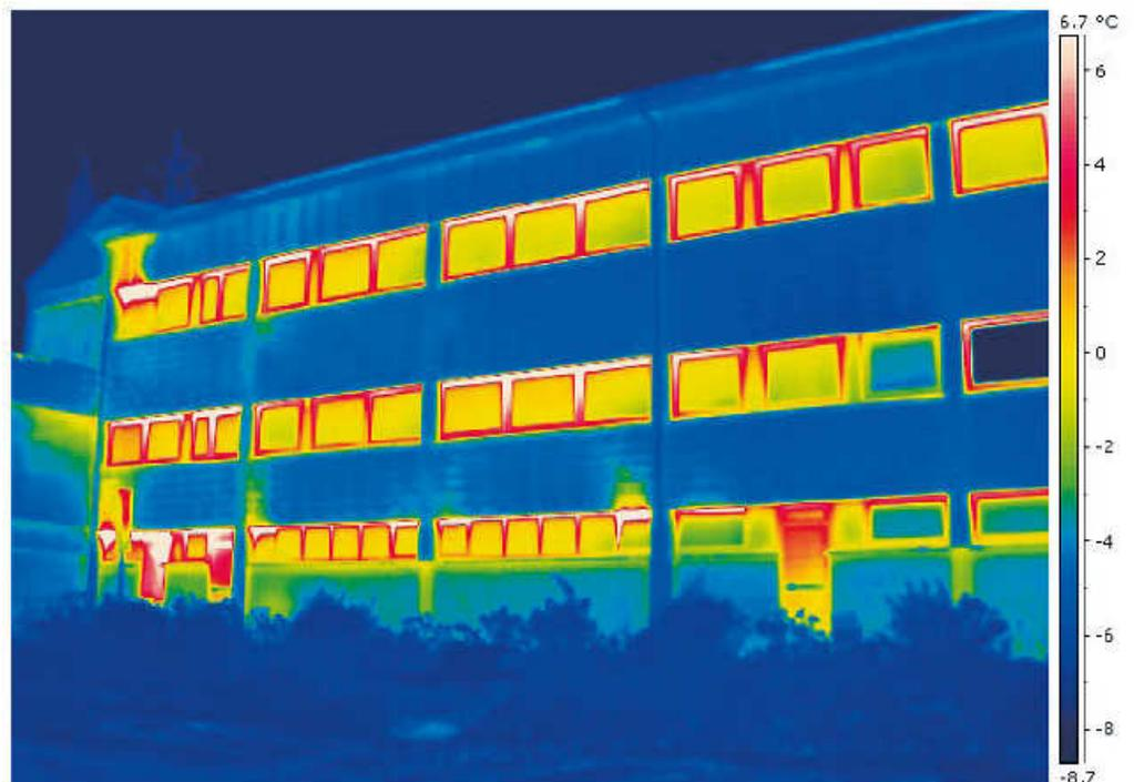
Thermografie-Checks lokalisieren Wärmebrücken und Wärmeverluste punktgenau. Flächen, an denen Wärme entweicht, werden auf den Bildern farblich dargestellt. Fotos: avr
