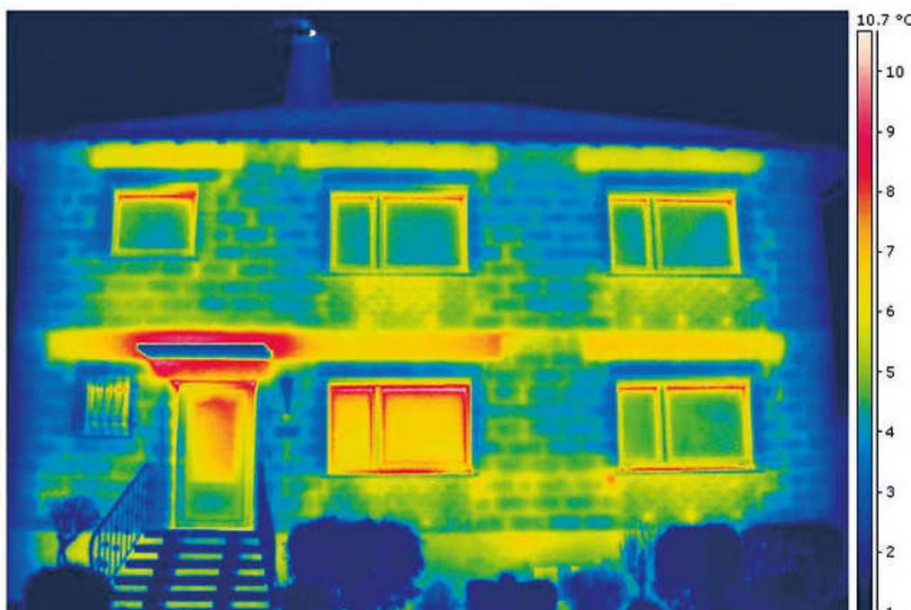
Thermografie-Checks lokalisieren Wärmebrücken und Wärmeverluste punktgenau. Flächen, an denen Wärme entweicht, werden auf den Infrarotbildern farblich dargestellt.
